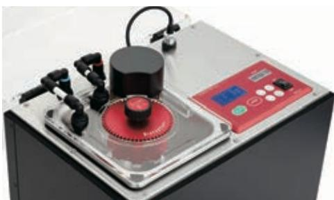
フレークアイスを冷媒として利用する冷水循環器です。一般的なチラーに比べ素早く4°C付近へ冷却を行います。専用設計の冷水循環器で BIORUPTOR®-One の超音波発振タイミングとシンクロし超音波 OFF のタイミングで冷水を循環します。水流による超音波破碎効率に影響を与えません。
