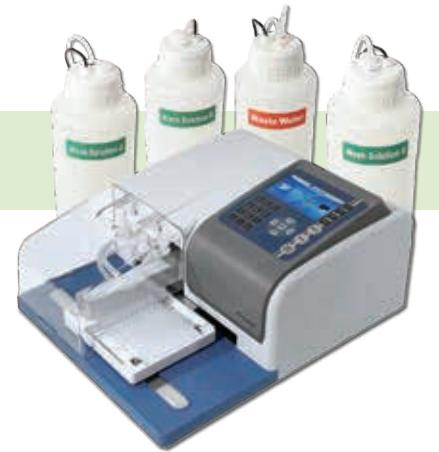
研究には柔軟性が必要ですが、SmartWasher™ 96 はそれを提供します。この全自动ウォッシャーは、U、V、C、または平底のフルプレート、部分プレート、ストリップに対応しています。複数の吸引ポイント設定により、吸引後のウェル内の残留液体を最小限に抑えることができます。分注量、吸引時間、ソーカ・振とうサイクル、振とう速度など、すべてのパラメータは 4.3 インチの大型 LCD ディスプレイとキー パッドで簡単にプログラムできます。最大 100 の洗浄プロトコールを SmartWasher™ 96 に保存し、必要なときに呼び出したり、フラッシュドライブを使って装置間で転送したりすることができます。
