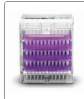
一番下のインサートをつかみ、ラックからスリーブを持ち上げて、スリーブ全体を空ラックに移します。スリーブの穴をラッタおよび背面のフタの突起部にしっかりと合わせます。
