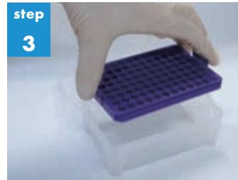
リフィルプレートの突起部を軽く押込みながら持ち上げます。
