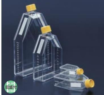
◆ ピペットティングやセルスクレーパーなどが細胞を掻き出す際に、フラスコ底面の角に楽に届くネック構造
