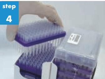
リフィルシステムよりチップの充填されたリフィルプレートを1プレート取り出します。
