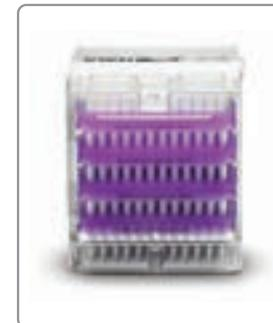
一番下のインサートをつかみ、ラックからスリーブを持ち上げて、スリーブ全体を空ラックに移します。スリーブの穴をラッチおよび背面のフタの突起部にしっかりと合わせます。
