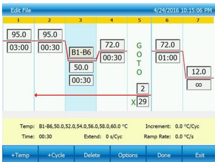
Figure 12 グラジエント表示画面
