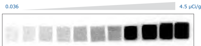
Figure 1. American Radiolabeled Chemicals Carbon-14 標準試料を Storage Phosphor Screen に 3 時間暴露し、Sapphire Biomolecular Imager で画像化した。
