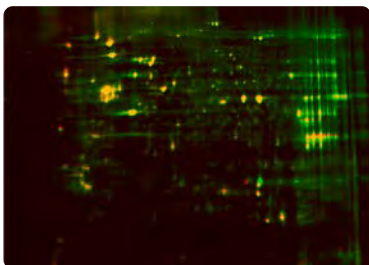
ゲル内蛍光染色（二次元電気泳動） 未処理のHeLaライセートをCy3、処理したHeLaライセートをCy5でそれぞれ標識し、同時に分離した。その後、Sapphire Biomolecular Imagerの520nmと658nmのレーザーを用いて、100μmでスキャンした。
