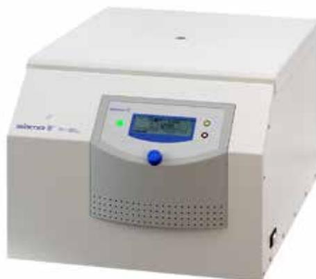
Sigma4-5L 遠心分離機は、研究業務はもちろんのこと、研究室での日常的な作業にも対応できるように設計されています。また、13mm 採血管の場合最高144本、16mm 採血管の場合最高100本と同クラスの遠心機に比べ25%収容能力が向上しています。特許取得済みのワンノブ式Spincontrol Lコントローラーは、優れた操作性、安全性、汎用性を提供します。直感的なユーザーインターフェースと明確に整理されたメニュー構造により、運転パラメータの入力と調整を素早く行うことができます。加速・制動曲線（各10本）は、分離運転と結果の最適化を容易にします。
