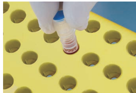
専用ラックは片手でフタを開閉できる構造になっています。
