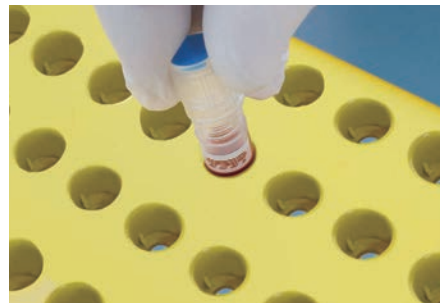
専用ラックは片手でフタを開閉できる構造になっています。
