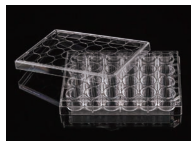
蒸発を抑制するために特別に設計されたフタ
