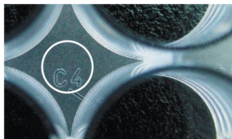
全てのプレートの底面にはウェルNo.が入っています
