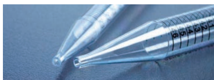
先端は液切れが良く、液もれがない形状になっています。
