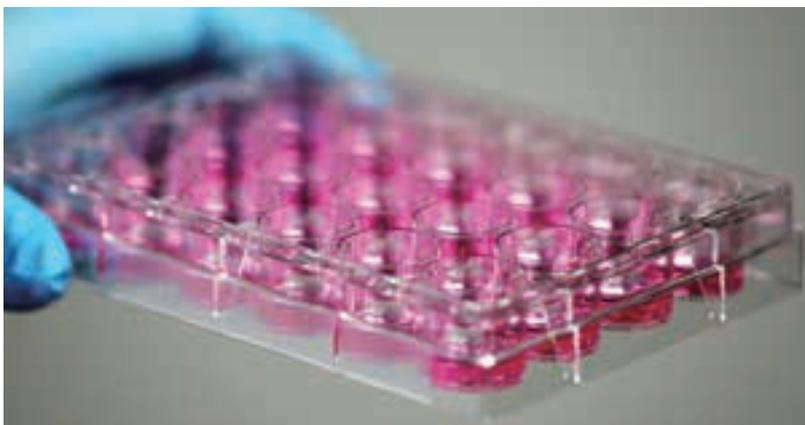
NEST社の細胞培養プレートはコーナーが丸みを帯びており取り扱いやすくなっています。背が低く蒸発を抑えるようデザインされたフタは均一な増殖を保証します。培養表面を組織培養用に処理されたプレートと未処理プレートの両方のご用意があります。未処理プレートの表面は細胞培養用に処理された表面よりも疎水性が高く、細菌培養用のペトリディッシュに近いものになっています。その四隅にある短い脚により顕微鏡レンズに傷がつくことを防いでいます。
