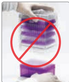
一番下のインサートをつかみ、ラックからスリーブを持ち上げて、スリーブ全体を空ラックに移します。スリーブの穴をラッチおよび背面のフタの突起部にしっかり合わせます。
