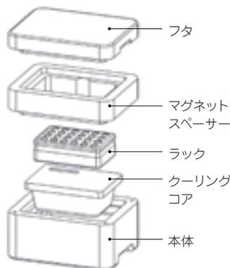
CoolBox™ システムは、ベース、クーリングカートリッジ、蓋で構成されています。CoolBox™ XTにはマグネットスパーサーが含まれ、1℃～8℃の温度帯をインジケータで確認することが出来ます。CoolBox™ は熱伝導モジュールを合わせて使用できるようデザインされています。
