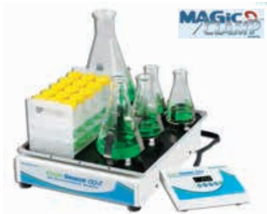
Orbi-Shaker™ CO<sub>2</sub>シリーズは、CO<sub>2</sub>インキュベーターを含む過酷な環境下でのシェーキング、ミキシング&エアレーションアプリケーション用に設計されています。0℃~65℃の温度と100%までの湿度レベルに耐えることができます。コンタミネーション、意図しないガスの放出、プロトコルからの逸脱を避けるため、すべての設定は付属のリモートコントロールモジュールで調整します。このモジュールはチャンバー外に設置することができ、フラット（1mm厚）ケーブルでシェーカーと接続し、ポートやインキュベーターのドアの下を簡単に通すことができるので密閉性を損なうことはありません。これにより、チャンバーのドアを開けることなく、ユーザーが運転時間やミキシングスピードを調整することができます。
