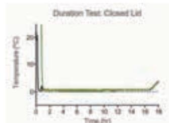
CoolBox™ XTシステムは、Cooling Coreを使用した場合、4℃以下を、蓋をあけた状態で、10時間、蓋を閉めた状態で、16時間温度を保つことが出来ます。
