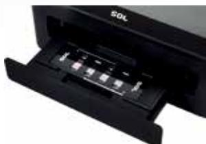
SOL COUNT 全自動セルカウンターは、レンズレスLED光学系とCMOSセンシング技術により、細胞の総数、生細胞、死細胞を迅速かつ正確に測定し、データの保存と転送を容易に行うことができます。使い捨ての4チャンネルカートリッジを採用しているため、使い勝手がよく、2種類のサンプルを同時に測定することが可能です。また、コンパクトで携帯性に優れているため、モバイルラボに設置することが可能です。
