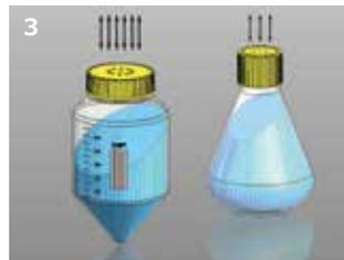
1. シーキングインキュベーターで使用します。容量を変えても同じ回転速度でサンプルがシェーキングできるようになっています。
