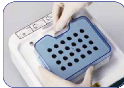
ブロックモジュールを交換するためのトグルハンドル
