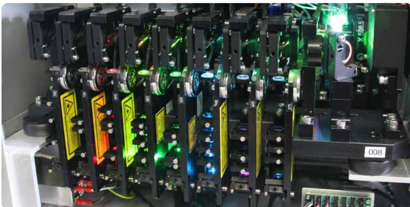
図7. 7レーザーを搭載したAmnis™ CellStream™ フローサイトメーターの内部
