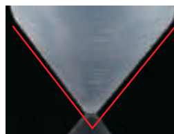
厚みを増したコニカル部分
