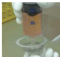
3. シリンジフィルターを取り付けます。
