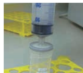
4. 吸い上げた溶液をろ過します。TPP50ml遠心管ならびったりとはまります。
